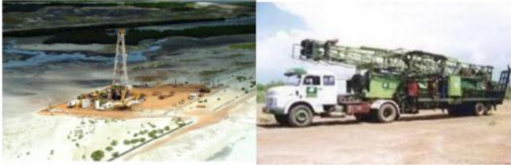
Figura 1: Foto da sonda montada (esquerda) e da sonda sendo transportada
